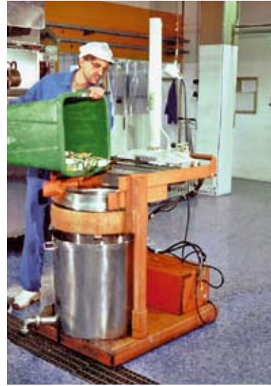
Flüssigkeitsabscheidung Gefährdete Teile sind aus rostfreiem Stahl gefertigt.
