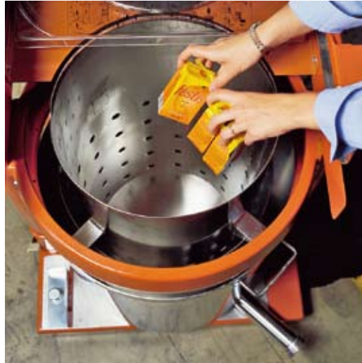
Während der Verdichtung läuft die Flüssigkeit aus der 1,27 cm – Leitung.
